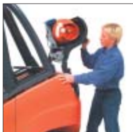
Le remplacement des bouteilles de gaz s'effectue sans effort et rapidement grâce à l'ouverture assistée par un vérin du carter bouteille.
