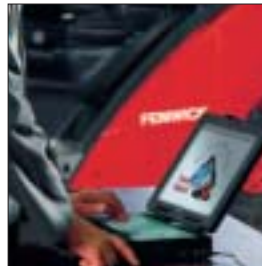
La prise diagnostic permet au technicien, via son ordinateur portable, de rechercher les causes et de résoudre rapidement les incidents détectés.
